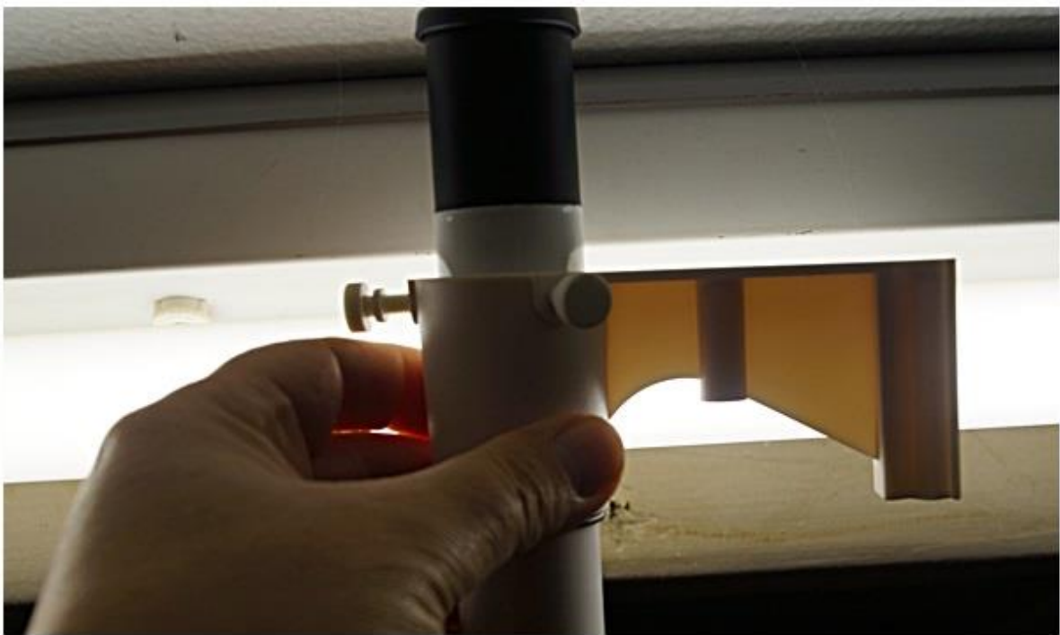
die Sucherhalterung im "Durchlicht" zeigt, welch dünnes Kunststoffmaterial hier verwendet wurde !
