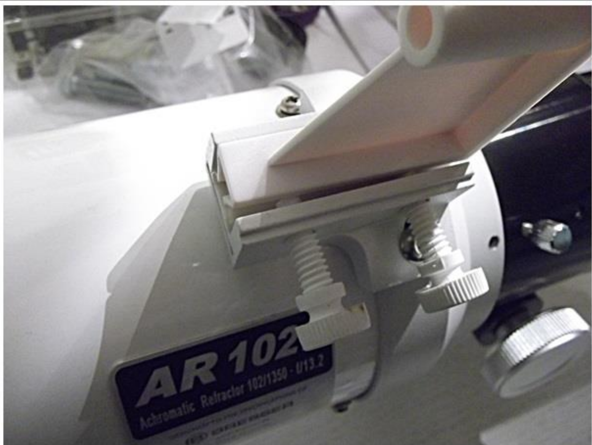
der extrem dünnwandige und schwabbelige Sucherhalter verzieht sich schon bei der Klemmung im Sucherschuh....
