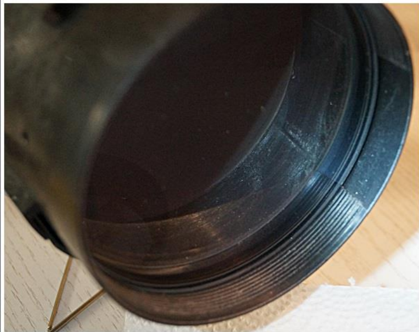
nicht voll umfängliches Gewinde in der Plastikfassung zur Aufnahme des Plastik-Verschraubinges
