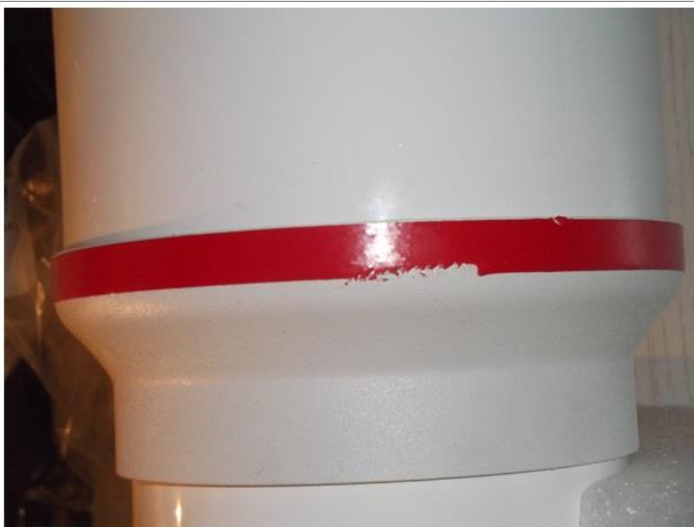
Im Anlieferungszustand bereits abgeriebener Zierstreifen
