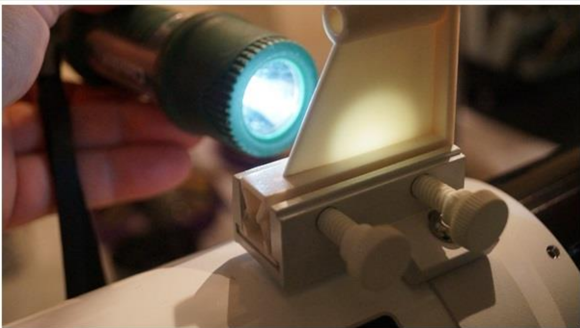
Durchleuchtung der dünnen Sucherhalterung..
