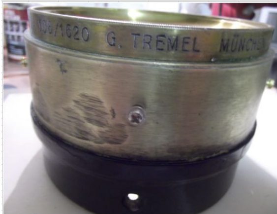
falsche PC Schraube zur Befestigung der Taukappe !
