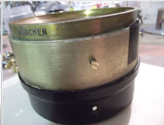
richtige Messing-Schraube zur Befestigung der Taukappe !
