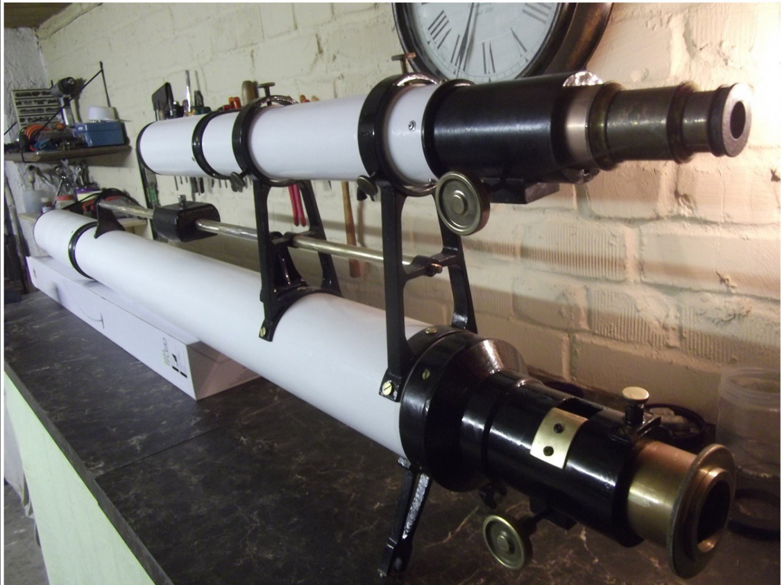
Piet Meester Refraktor im nahezu finalen Zustand Hauptoptik G. Tremel Achromat 108/1620 mm und Leitrohr-Optik G. Tremel 55/650 mm
